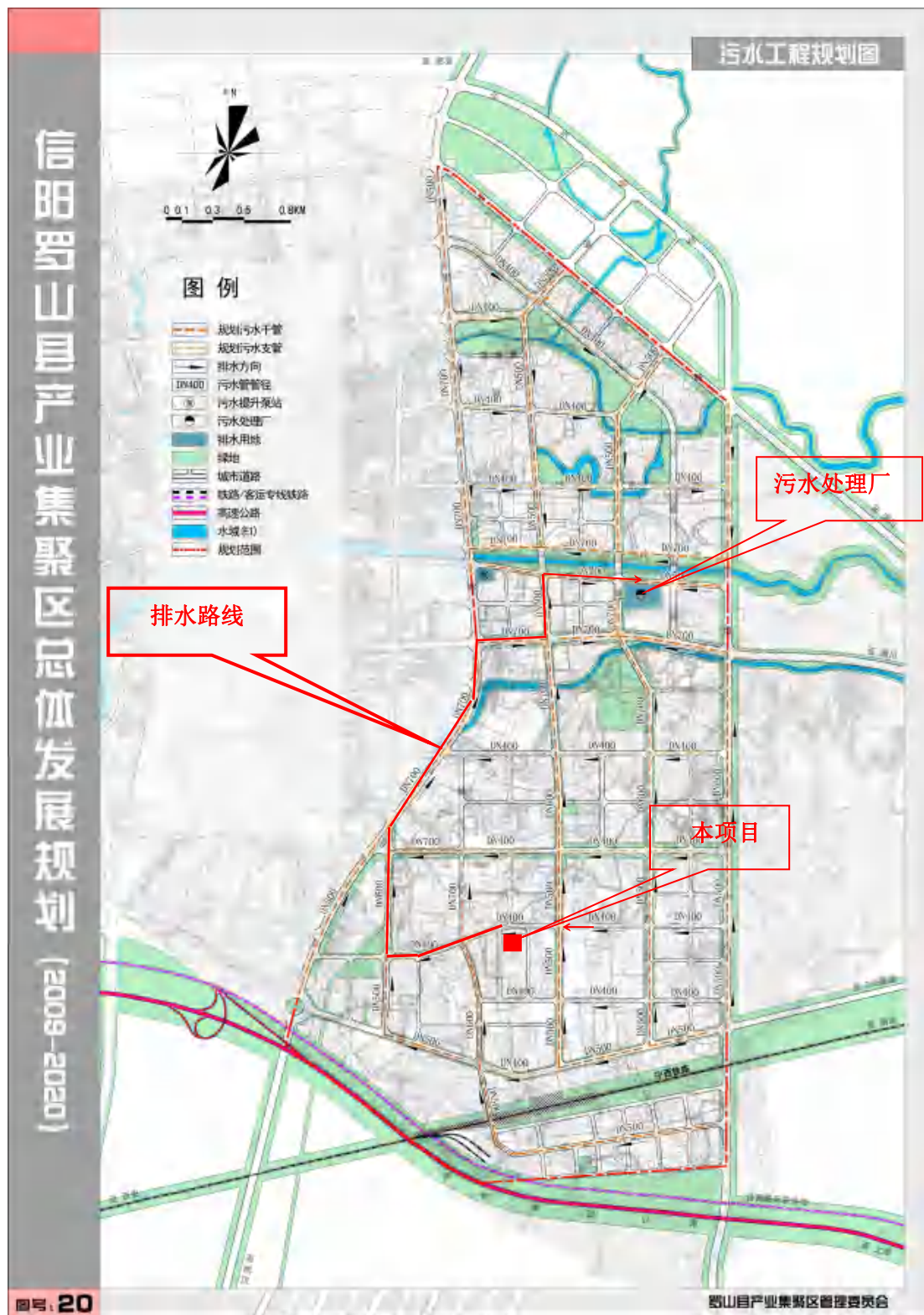
附图五 污水管网及排水路线图
