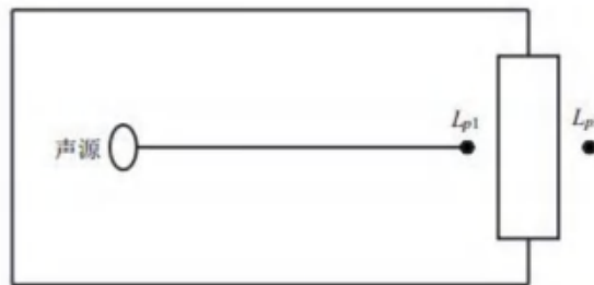
图 4-1 室内声源等效为室外声源示意图
